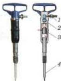
Рис. 104. Внешний вид и устройство пневматического молотка
