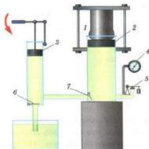
Рис. 145. Устройство гидравлического пресса
