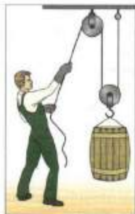
Рис. 181. Комбинация подвижных и неподвижных блоков — полиспаст
