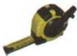
Рис. 6. Приборы для измерения длины: а — линейка; б — рулетка
