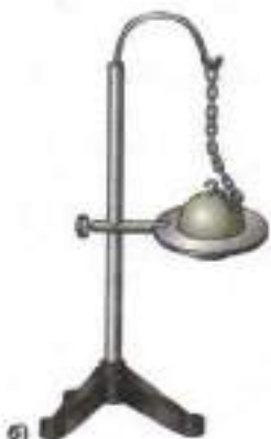
Рис. 18. Тепловое расширение металлического шара
