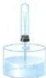
Рис. 126. Поступление воды внутрь сосуда из-за разности атмосферного давления и давления в закрытом сосуде
