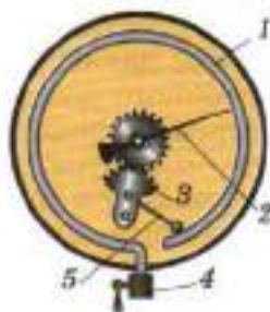
Рис. 141. Устройство металлического манометра
