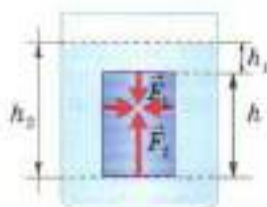
Рис. 148. Силы, действующие на погружённое в жидкость тело
