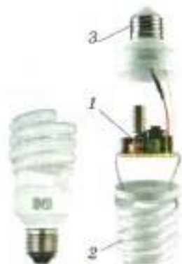
Рис. 88. Энергосберегающая лампа: 1 — электронный блок; 2 — стеклянная колба, покрытая люминофором; 3 — цоколь
