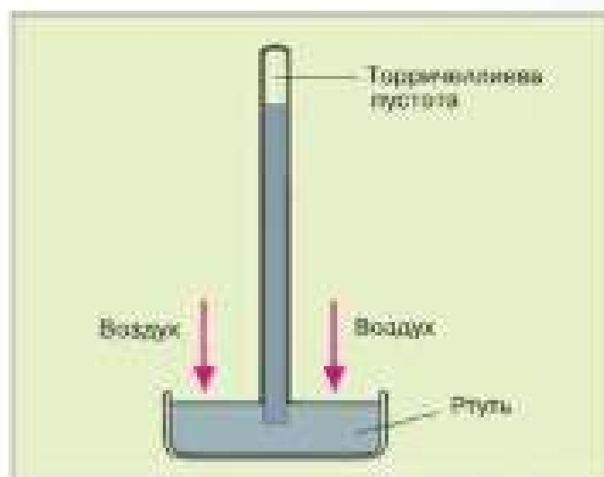
Рис. 89. Барометр Торричелли и принцип его действия
