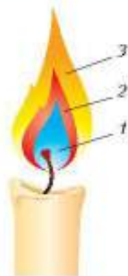
Рис. 8. Строение пламени. Разные зоны обозначены различными оттенками: 1 – тёмное, негорячее; 2 – яркое, горячее; 3 – менее яркое, самое горячее
