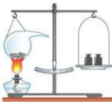
Рис. 32. Сохранение массы веществ при прокаливании железа в запаянной реторте
