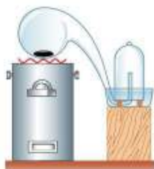
Рис. 53. Опыт Лавуазье по определению состава воздуха
