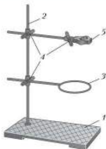
Рис. 9. Лабораторный штатив: 1 – подставка; 2 – стержень; 3 – кольцо; 4 – зажим; 5 – лапка
