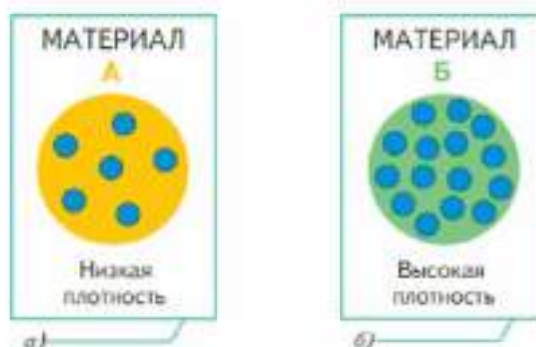
Рис. 6.1. Схема размещения молекул в материалах разной плотности
