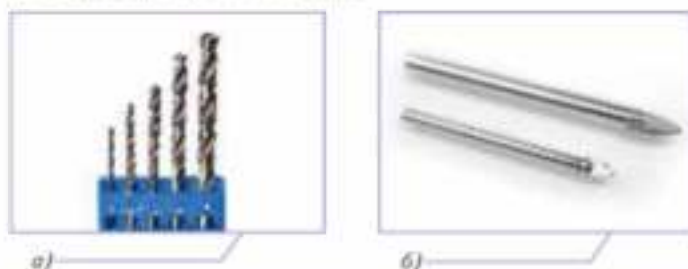
Рис. 5.22. Свёрла для сверления строительных материалов: а — с наконечниками из твёрдых сплавов; б — для сверления керамики и стекла
