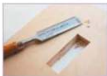
Рис. 5.11. Выполнение отверстия долотом
