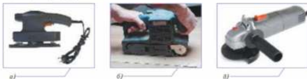
Рис. 5.19. Ручные электрифицированные шлифовальные машинки: а — вибрационная; б — ленточная; в — ротор-орбитальная
