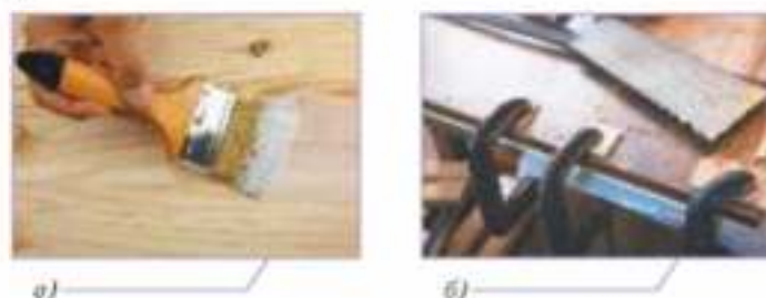
Рис. 6.7. Этапы склеивания деталей: а — смазывание клеем; б — сжатие струбцинами склеиваемых деталей
