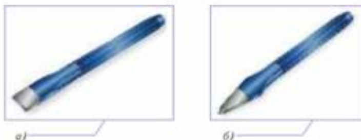
Рис. 5.14. Рубка металлов: а — зубило; б — крейцмейсель
