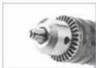
Рис. 5.10. Патрон для крепления свёрл (а); образцы свёрл (б); наиболее распространённые виды свёрл (в): 1 — спиральное; 2 — винтовое; 3 — перьевое
