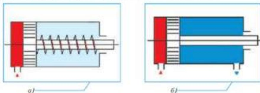
Гидроцилиндры, как и пневмоцилиндры, могут иметь и двухстороннюю подачу жидкости под давлением (рис. 4.6, б). Жидкость под давлением подаётся то с одной, то с другой стороны цилиндра.
